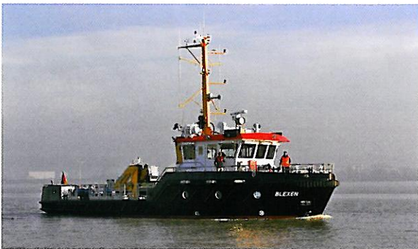
„Blexen“ Aufsichts- und Arbeitsschiff Baujahr 2011; 99 BRZ; Länge 23,90 m; Breite 6,90 m; Tiefgang 1,50 m; Antrieb 361 kW; Geschwindigkeit 10,3 Knoten
