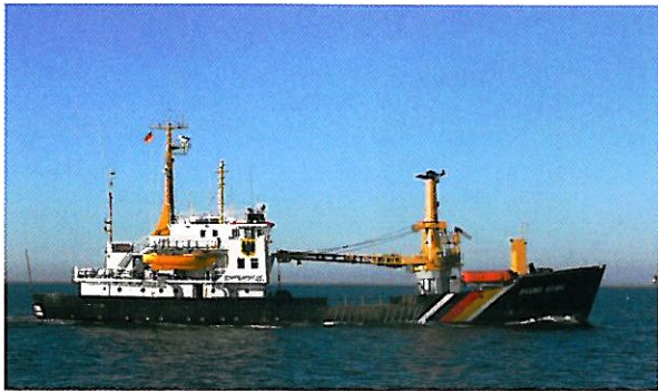
„Bruno Illing“ Seeeichenfahrzeug Baujahr 1968; 493,90 BRT; Länge 48,80 m; Breite 9,50 m; Antrieb D 1119 kW, Aktivrunder; Geschwindigkeit 13,7 Knoten; wird Ende 2012 ersetzt.
