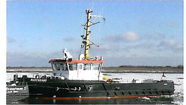
„Ruschsand“ Schub- und Mehrzwegschiff Baujahr 2009; 133 BRZ; Länge 24,20 m; Breite 6,60 m; Tiefgang 1,60 m; Antrieb 2 x 301 kW Festpropeller und 50 kW Bugstrahlruder; Geschwindigkeit 9,7 Knoten
