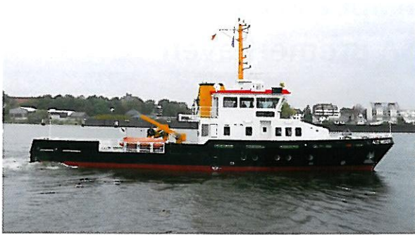
„Alte Weser“ Seezeichenfahrzeug Baujahr 2008; 215 BRZ; Länge 34,20m; Breite 7,50 m; Tiefgang 2,00 m; Antrieb 2 Cummins-Motoren mit je 559 kW auf Voith-Schneider-Antrieb; Geschwindigkeit 14,2 Knoten
