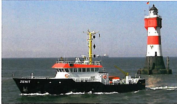
„Zenit“ Peilschiff Baujahr 2004; 108 t Verdrängung; Länge 30 m; Breite 6,50 m; Tiefgang 2,00 m; Antrieb Cummins KTA 19-M3, 447 kW; Geschwindigkeit 12,5 Knoten
