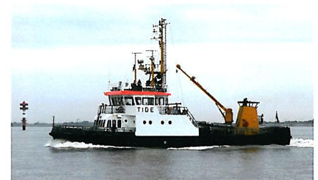
„Tide“ Gewässerkundliches Messschiff Baujahr 1990; 219 BRT; Länge 31,60 m; Breite 7,50 m; Tiefgang 2,00 m; Antrieb MWM 514 kW; Geschwindigkeit 11,3 Knoten
