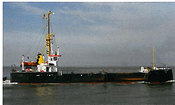
„Granit“ Transportschiff mit Steinstürzvorrichtung stationiert im Außenbezirk Blexen; Baujahr 1986; 157 BRT; Länge 40,15 m; Breite 8,05 m; Tiefgang 1,28 m; Antrieb MWM 232 kW; Geschwindigkeit 8,1 Knoten
