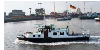
„Brake“ Fahrzeug für Personen- und Materialtransport Baujahr 1964; Verdrängung 22 cbm; Länge 16,22 m; Breite 3,80 m; Tiefgang 1,20 m; Antrieb 105,84 kW; Geschwindigkeit 9,6 Knoten
