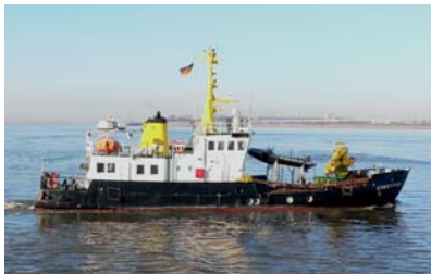
„Eversand“ Seezeichenfahrzeug Baujahr 1973; BRT 125; Länge 29,30 m; Breite 6,20 m; Tiefgang 1,50 m; Antrieb Deutz 330 kW; Geschwindigkeit 10,5 Knoten
