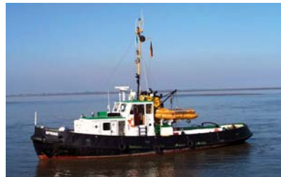
„Spring“ Schlepper Baujahr 1957; 57 BRT; Länge 20,83 m; Breite 5,81 m; Tiefgang 1,90 m; Antrieb 189 kW; Geschwindigkeit 10,3 Knoten
