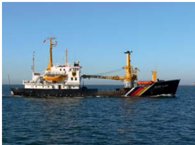
„Bruno Illing“ Seezeichenfahrzeug Baujahr 1968; 493,90 BRT; Länge 48,80 m; Breite 9,50 m; Antrieb D 1119 kW, Aktivrunder; Geschwindigkeit 13,7 Knoten
