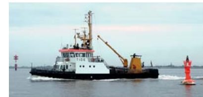
„Tide“ Gewässerkundliches Messschiff Baujahr 1990; 219 BRT; Länge 31,60 m; Breite 7,50 m; Tiefgang 2,00 m; Antrieb MWM 514 kW; Geschwindigkeit 11,3 Knoten
