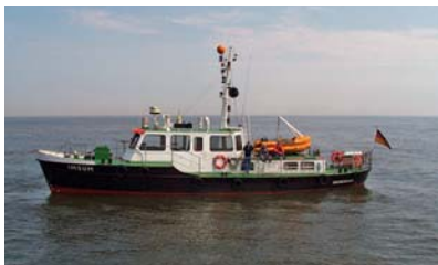
„Imsum“ Fahrzeug für Personen- und Materialtransport Baujahr 1953; 30 BRT; Länge 19,93 m; Breite 4,30 m; Tiefgang 1,55 m; Antrieb MWM 166 kW; Geschwindigkeit 10,0 Knoten
