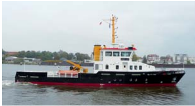
„Alte Weser“ Seezeichenfahrzeug Baujahr 2008; 215 BRZ; Länge 34,20m; Breite 7,50 m; Tiefgang 2,00 m; Antrieb 2 Cummins-Motoren mit je 559 kW auf Voith-Schneider-Antrieb; Geschwindigkeit 14,2 Knoten
