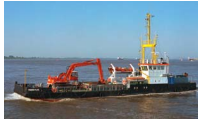
„Franzius Plate“ Fahrzeug mit mobilem Hydraulik-Bagger stationiert im Außenbezirk Blexen Baujahr 1987; 242 BRT; Länge 40,00 m; Breite 10,50 m; Tiefgang 1,20 m; Antrieb 2 MWM 194 kW; Schottel-Antrieb; Geschwindigkeit 8,0 Knoten
