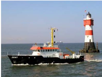
„Zenit“ Peilschiff Baujahr 2004; 108 t Verdrängung; Länge 30 m; Breite 6,50 m; Tiefgang 2,00 m; Antrieb Cummins KTA 19-M3, 447 kW; Geschwindigkeit 12,5 Knoten
