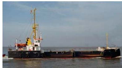
„Granit“ Transportschiff mit Steinstürzvorrichtung stationiert im Außenbezirk Blexen Baujahr 1986; 157 BRT; Länge 40,15 m; Breite 8,05 m; Tiefgang 1,28 m; Antrieb MWM 232 kW; Geschwindigkeit 8,1 Knoten
