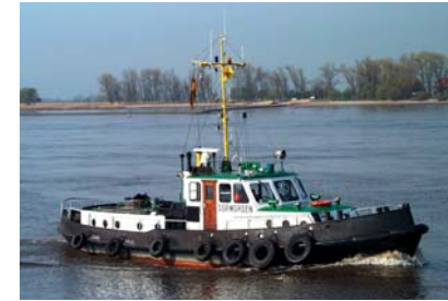
„Sürwürden“ Schlepper stationiert im Außenbezirk Blexen, Stützpunkt Klippkanne Baujahr 1963; 65 cbm Verdrängung; Länge 17,96 m; Breite 5,07 m; Tiefgang 1,76 m; Antrieb MTM 171 kW; Geschwindigkeit 9,0 Knoten
